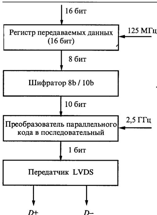
Рис.3. Блок-схема узла передатчика
