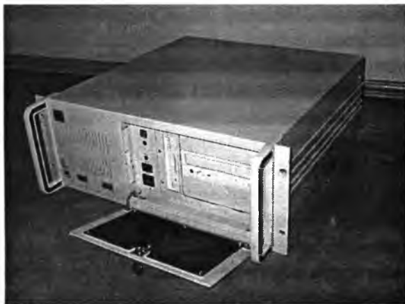
Рис.2. Промышленный персональный компьютер ККСН ЭКСПРО
