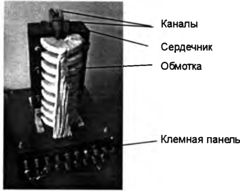
Рис.1. Индукционный двухручьевого МГД-насос
