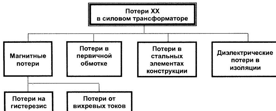
Рис. 1. Структура потерь ХХ в силовом трансформаторе
