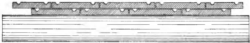
Рис. 27. Поперечный разрѣзъ части крыши въ „карту“.
