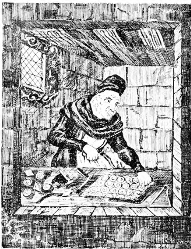
Рис. 42. Оконный мастер занят изготовлением стеклянного окна. Диаметр кружков 8—10 см. Рисунок взят из рукописи XVI в.
