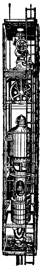
Рис. 410. Подвесной центробежный насос.
