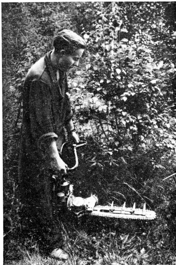
Рис. 6. Производственный момент работы пилой «Дружба» с приспособлением СК-1
