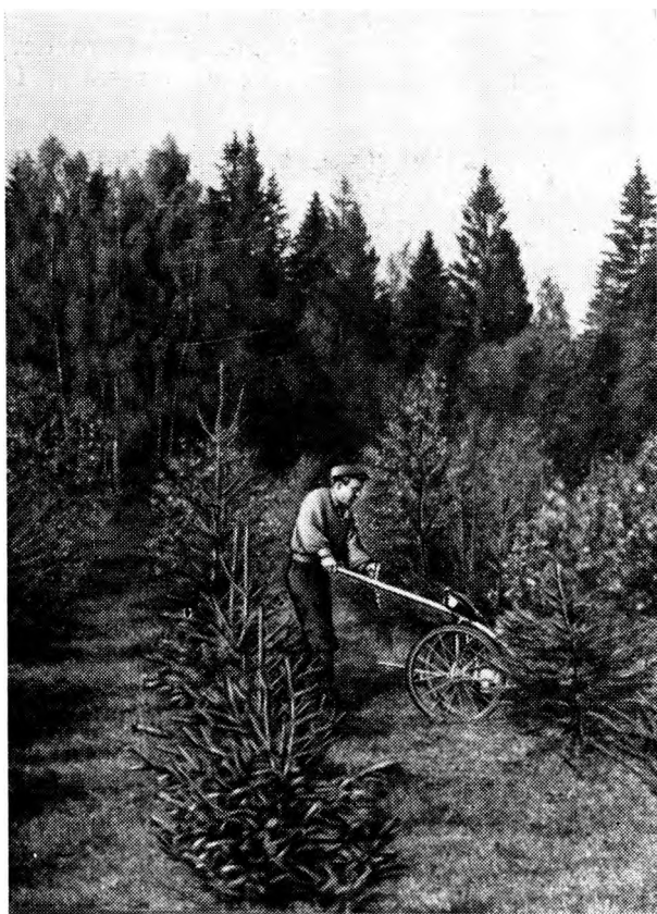
Рис. 8. Осветление культур ели с помощью передвижной мотопилы ММП-1 в Ново-Петровском лесхозе (Московская область)
