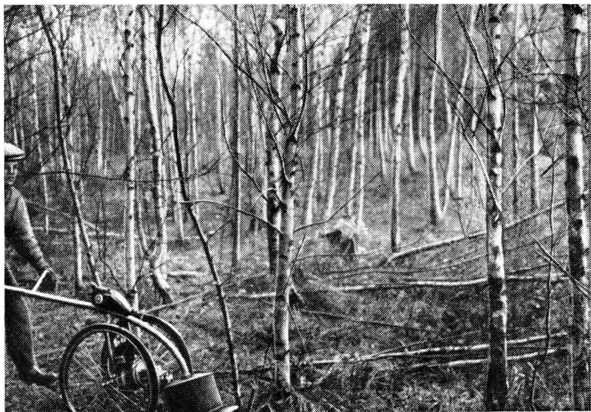
Рис. 10. Мотопила ММП-1 в работе на прочистке естественных молодняков в Ново-Петровском лесхозе (Московская область)
