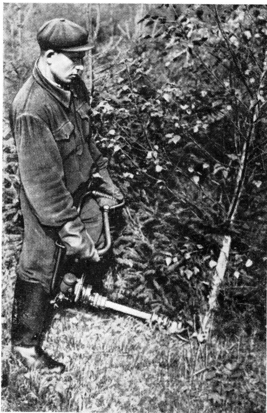
Рис. 9. Производственный момент работы с мотокусторезом МК-1 ЦНИИМЭ
