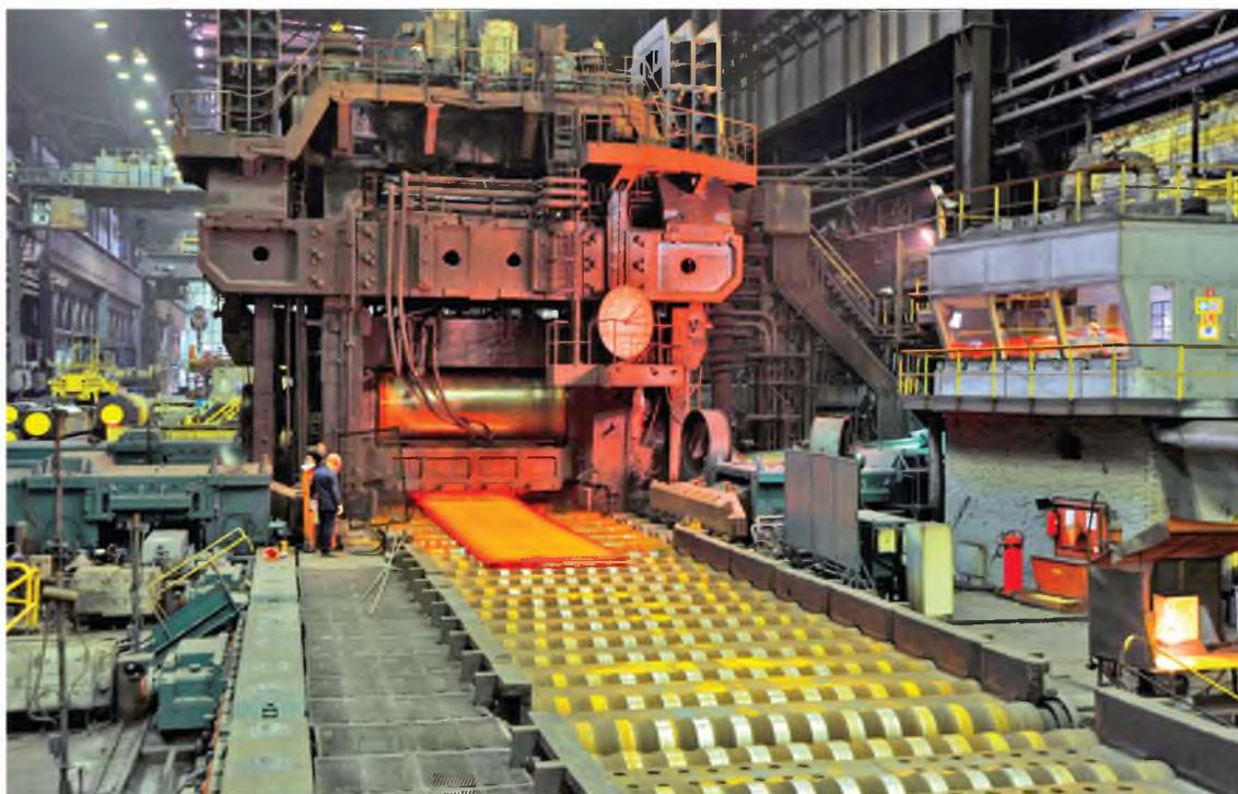
Стан «5000» – самый мощный в России по силе обжатия. После реконструкции на нем налажено изготовление штрипсов для производства труб большого диаметра.
