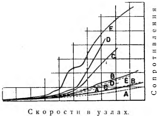
Рис. 29. —Кривые сопротивлений передвижению по воде для различного типа судов. Пунктирные линии —сопротивления, высчитанные по формулам; сплошные линии—сопротивления по данным опыта. A , для миноносца.— B , для большого контр-миноносца.— C , D для крейсеров различных водоизмещений и образований.— E , для грузового парохода.—Для крейсеров и грузовых пароходов разница столь значительна, что способ вычисления по формуле совершенно неприменим.
