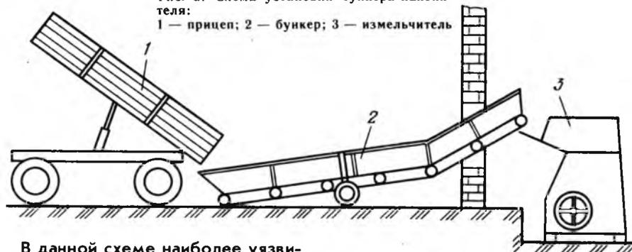
В данной схеме наиболее уязвимое место — ленточный транспортер типа ТЛ-4 (позиция 5), не исключающий ручной труд; на загрузку вручную 1 т тушек затрачивается не меньше 1 ч.
