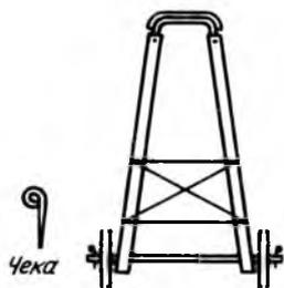
части трубки сверлят отверстие для оси. Диаметр ее 9...10 мм, длина 500 мм. В нерабочем состоянии ось хранится в одной из трубок, низ которой закреплен болтиком — получается посох.
