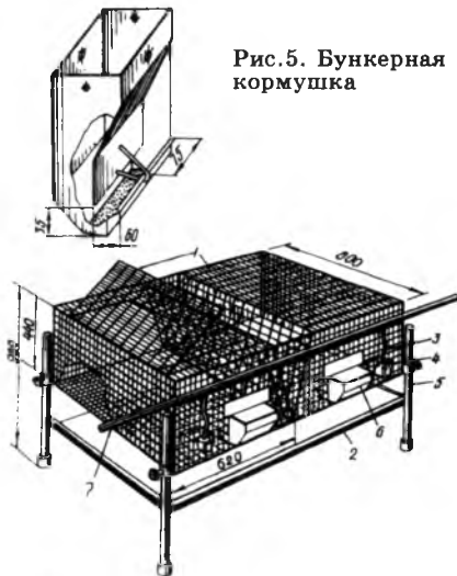
Рис. 6. Клетка КСК-1: 1 — дверцы; 2 — металлический поддон; 3 — гибкий шланг; 4 — поплавок поилка; 5 — стойка; 6 — бункерная кормушка; 7 — коллекторная трубка
