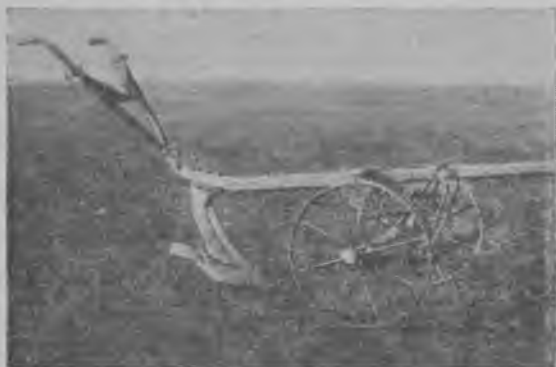
Рис. 5. Конный плуг для выкопки семян УЛ-3К
