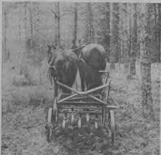
Рис. 6. Пружинный культиватор ПК-3
