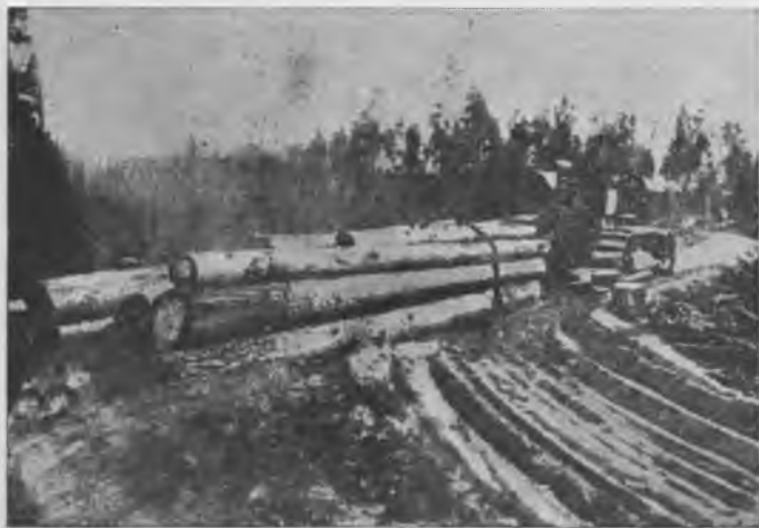
Рис. 1. Трелевка сортиментами на листах трактором ЧТЗ-60. Волокна I и II порядка на песчаной почве. Разрыхление поверхности волока при общем уплотнении почвы.
