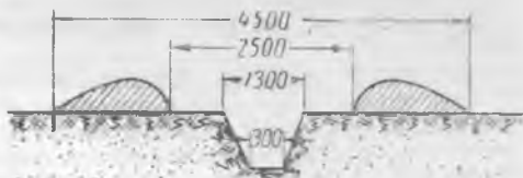
Рис. 2. Профиль канавы, отрываемой канавокопателем (размеры в миллиметрах).
