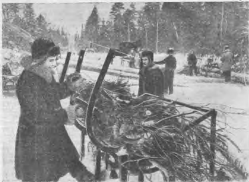
Прессовка сучьев на верхнем окладе в Сюрекском леспромхозе.
