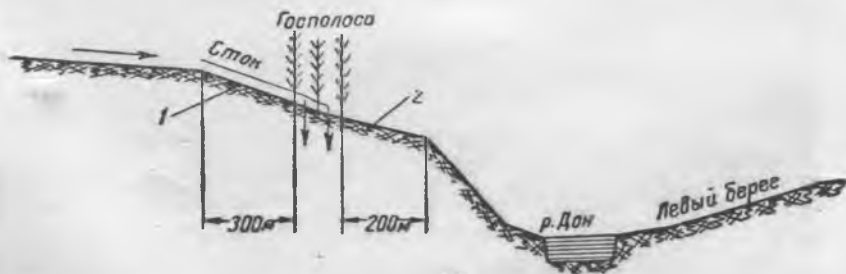
Рис. 3. Влияние лесной полосы на прилегающие земли на правом берегу Дона. 1 — площадь, сток с которой будет задержан полосой; 2 — территория, которая будет восстанавливаться под защитой лесной полосы.
