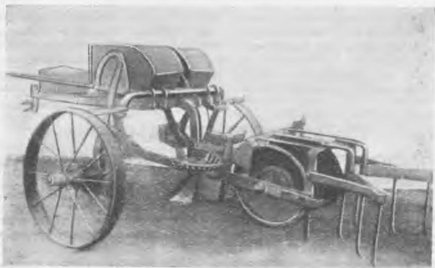
Рис. 1. Лесопосадочная машина СЛЧ-1.
