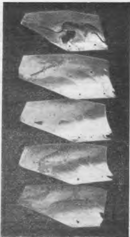
Рис. 2. Характерные явления износа отвалов у полевого обреза.
