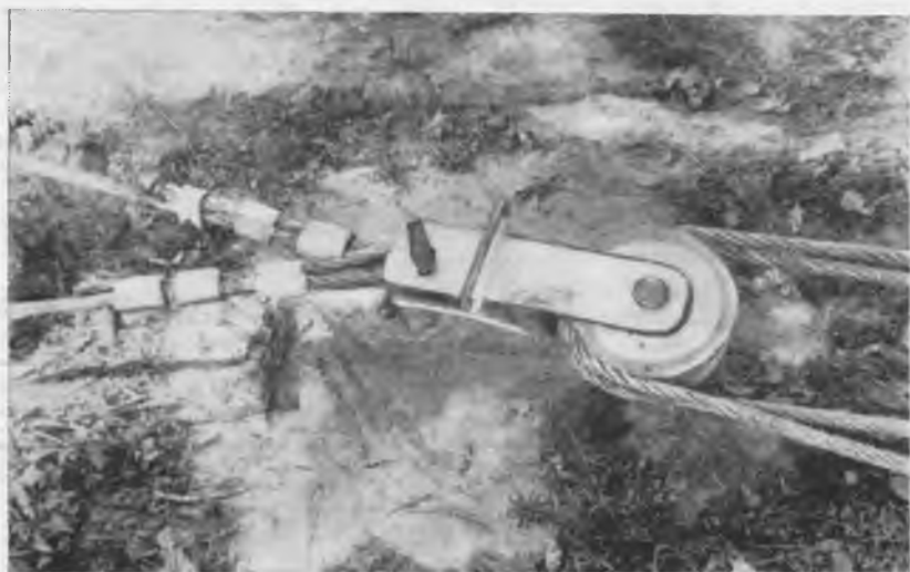
Общий вид двухролевого блока для корчевки пней.
