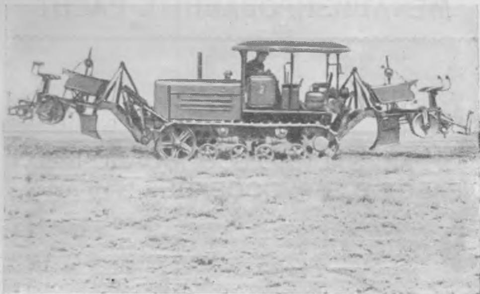
Рис. 9. Трактор ДТ-57 с лесопосадочной машиной.
