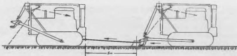
Рис. 3. Схема корчевания крупных пней при совместной работе двух тракторов.
