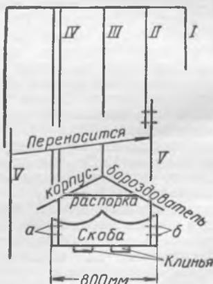
Рис. 4. Схема монтажа рам, корпуса-бороздвателя и скобы-углубителя.
