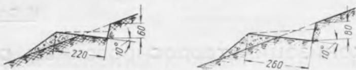
Рис. 2. Профили террасоканав, сделанных на склоне 20^\circ грейдером Д-20А за двукратный (слева) и трехкратный проход
