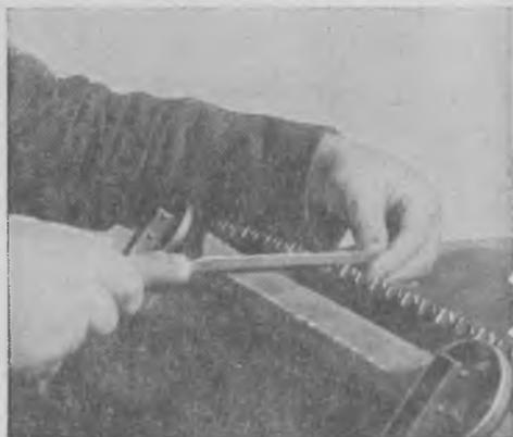
Рис. 3. Станок для правки пил.
