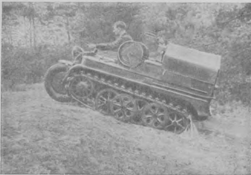
*Рис. 2. Малогабаритная самоходная электростанция на преодолении крутого подъема.*
