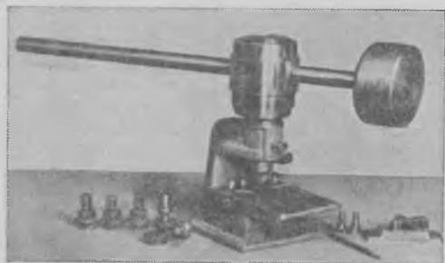
*Рис. 6. Штамп для насечки зубьев.*
