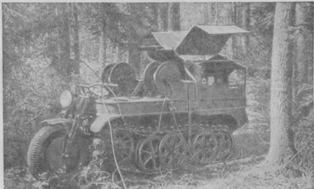
Рис. 1. Малогабаритная самоходная электростанция для лесорубочных работ.
