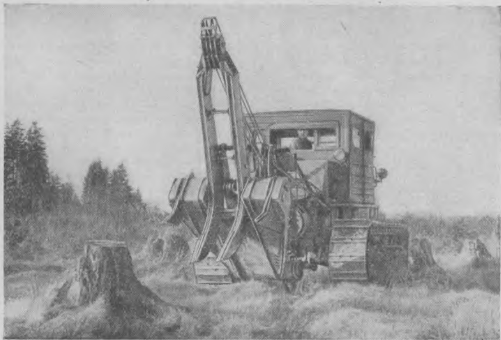
Рис. 1. Корчевальная машина ЦНИИЛХ при подходе к пню.
