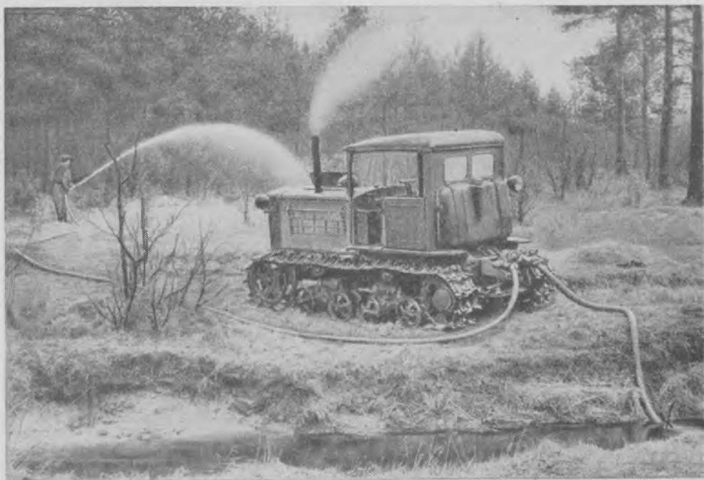
Рис. 3. Тракторный шестеренчатый насос ПНШ-3 на тракторе ДТ-54 во время работы.
