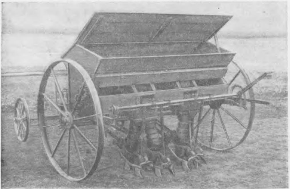
*Рис. 1. Сеялка для лесных семян с ленточным высевающим аппаратом.*
