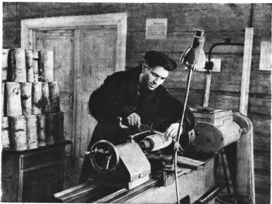
Обработка заготовок на токарном станке.
