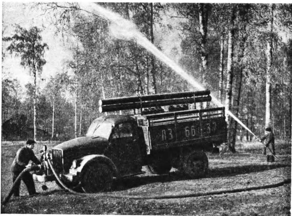
*Съемная пожарная автоцистерна конструкции ЦНИИЛХ, устан. овленная на автомашине ГАЗ-51.*
