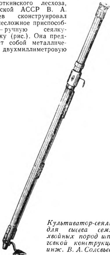
*Культиватор-сеялка для посева семян хвойных пород шпиговкой конструкции инж. В. А. Соловьева.*
