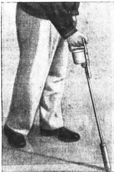
*Рис. 7. Ручной инструмент для посева семян (США).*
