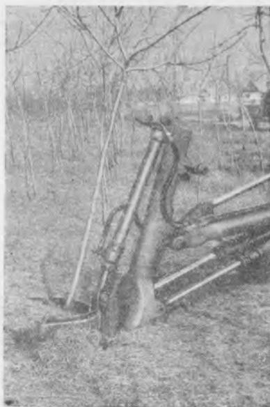
Рис. 4. Полное погружение лопаты в почву.
