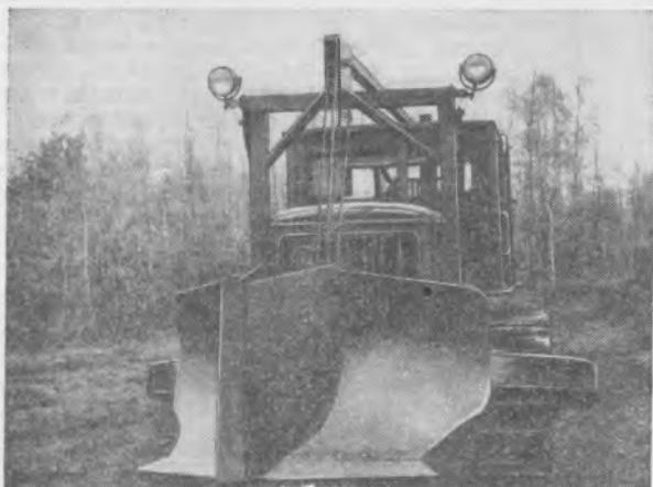
Рис. 3. Двухотвальный навесной плуг ПЛП-135 к трактору С-80.
