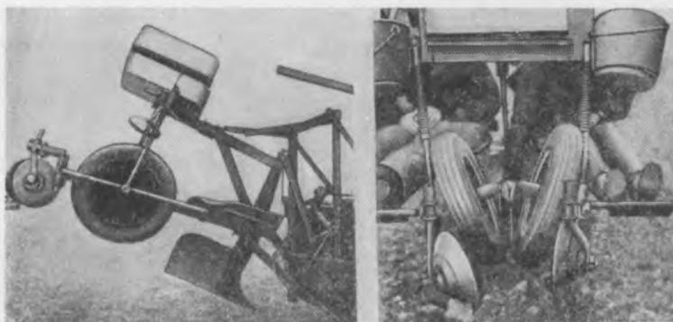
Рис. 10 Лесопосадочная машина системы Паттона (СП) в транспортном и рабочем положении.
