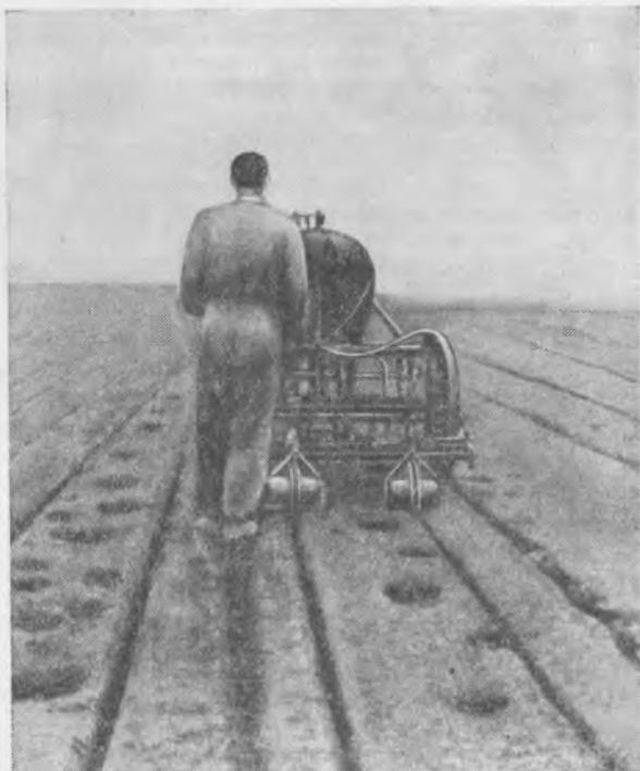
Рис. 13. Орудие Wespe для изготовления посадочной щели.
