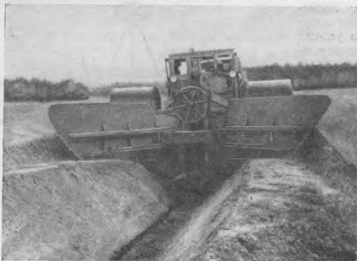
*Рис. 1. Реконструированный канавокопатель ЛК-2, колеса сделаны двойной ширины.*
