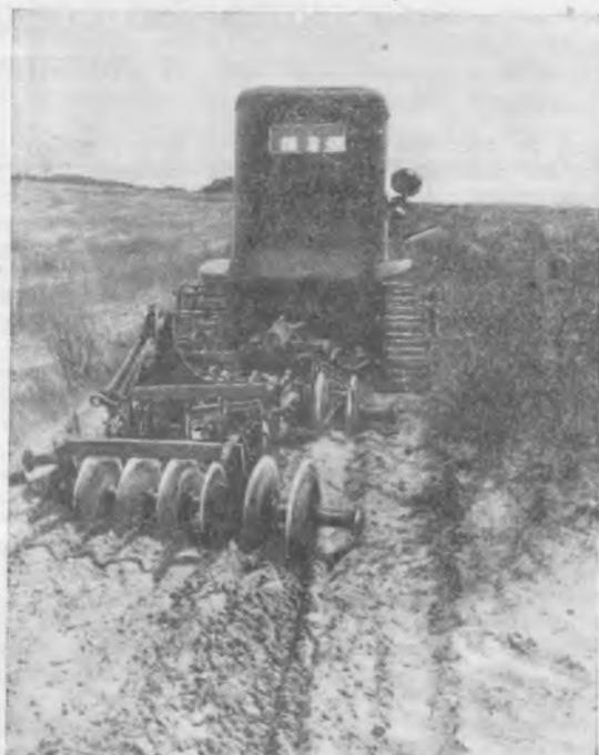
*Рис. 2. Переоборудованная дисковая борона.*
