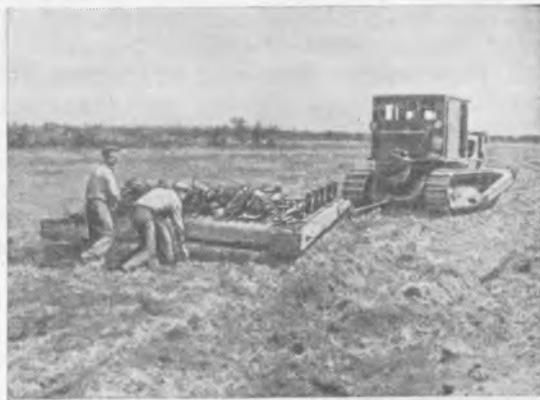
*Рыхление почвы, вычесывание корней и мелких пней корчевальной бороной.*
