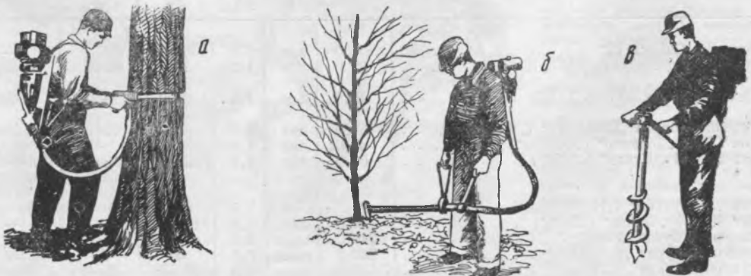
Рис. 2. Набор рабочих органов «Little Beaver»: а) окольцеватель; б) сучкорезка и в) бурав в рабочем положении.
