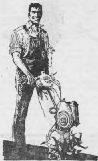
Рис. 11. Переносная моторизованная мотыга — фреза «Solo» (ФРГ).
