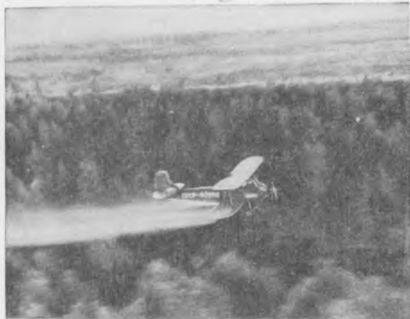
Опрыскивание препаратом 2,4Д ивы русской с самолета ПО-2А (с. Ровное, Саратовской области, остров Гай).
