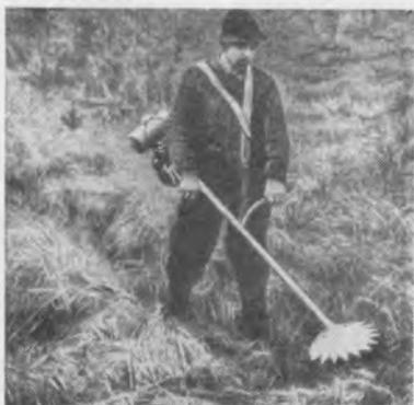
Рис. 11. Косилка-кусторез «Визель».
