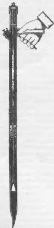
Рис. 1. Сеялка-трость из дюралевой трубки диаметром 15—30 мм с рукояткой
