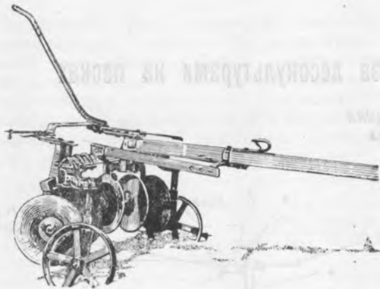
Рис. 2. Для транспортного положения культиватор снабжен двумя колесами
