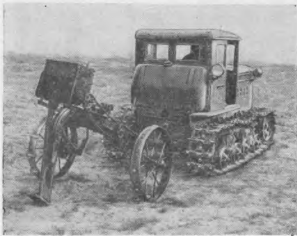
Плуг ПЛ-70, переоборудованный Цюрупинским лесхозом в рыхлитель с приспособлением для внесения в почву гексахлорана.
