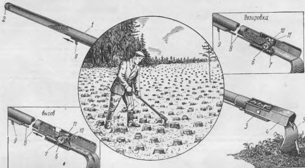
Ручная сеялка-шпиговка для посева семян хвойных инж. В. А. Соловьева:
