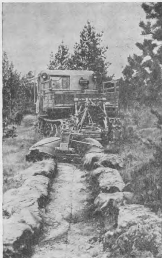
Прокладка противопожарных полос лесохозяйственным трактором Т-47 с плугом ПКЛ-70. Государственные испытания в Таежной МИС.
