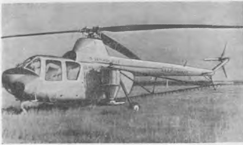
Вертолет Ми-1, оборудованный опыливателем и опрыскивателем.
