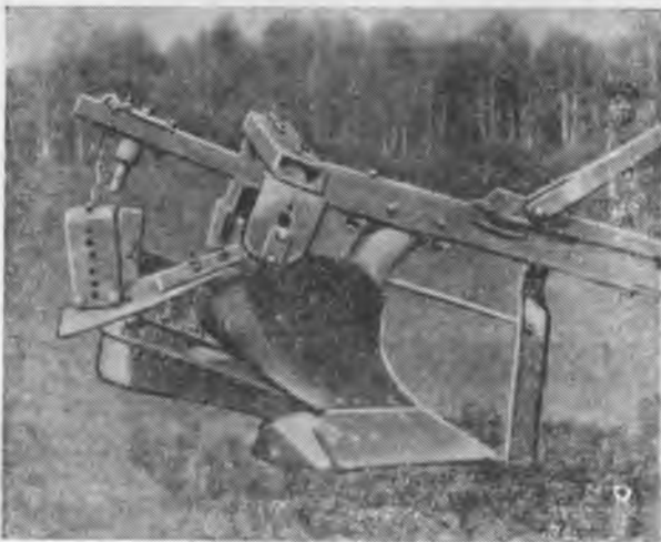
Рис. 2. Плуг ПКЛ, оборудованный приспособлением для отваливания пласта.
