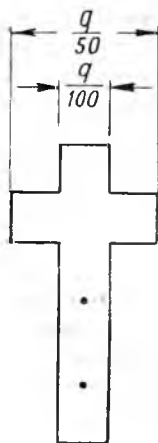
Рис. 1. Металлическая пластинка, устанавливаемая на конце вилки, \delta — длина линейки.
