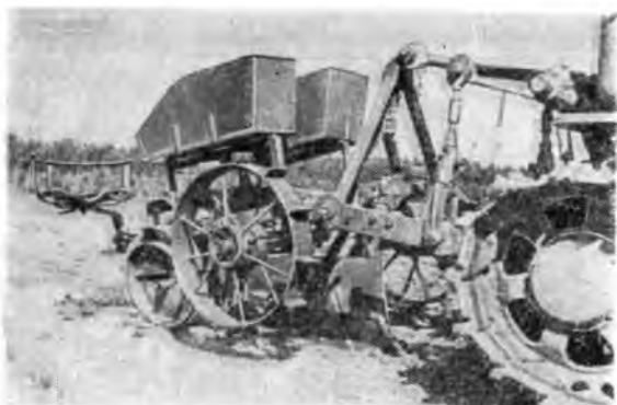
Рис. 1. Лесопосадочная машина СЛН-1, навешанная на тракторе ДТ-54 А.
