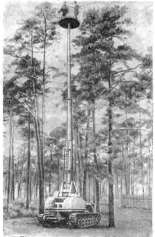
Рис. 11. Самоходный семеновборочный агрегат в рабочем положении.
