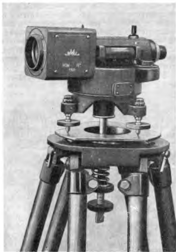
Рис. 7. Нивелир с самоустанавливающейся визирной осью НСМ.
