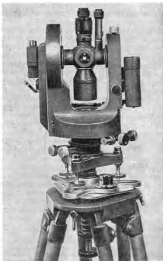
Рис. 3. Оптический теодолит ОМТ-30.
