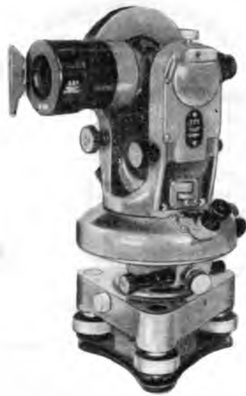
Рис. 4. Теодолит-тахеометр ТТ-5 с дальномерной насадкой ДД-3.
