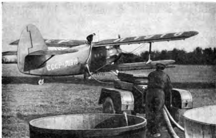
Загрузка самолета вирусной суспензией мотопомпой ММ-1200.
