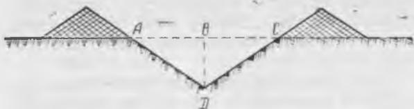
Рис. 2. Схема борозды двухотвального профиля (поперечное сечение). ВД — глубина борозды, АС — ширина борозды.
