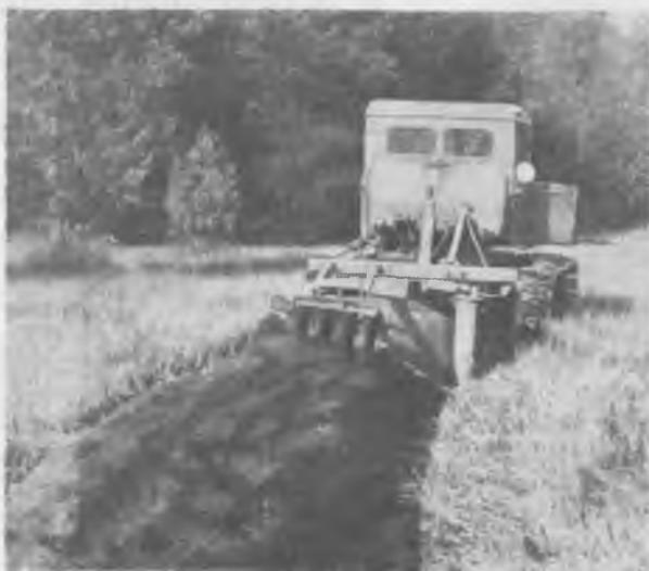
*Рис. 2. Рыхление поверхности перевернутого пласта дисковым рыхлителем.*
