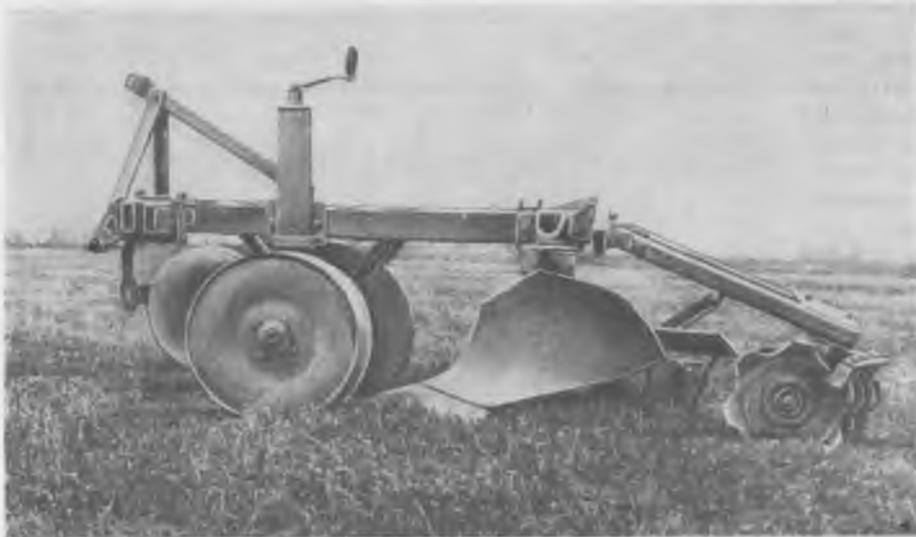
*Рис. 1. Плуг ПБН-60 с приспособлением для нарезки дренажных борозд.*
