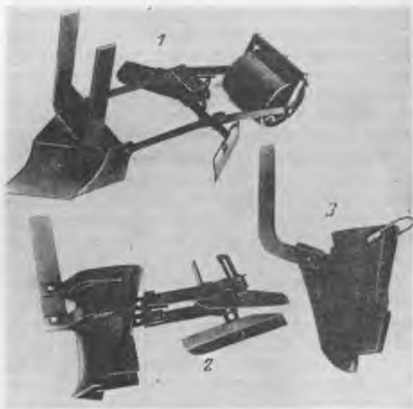
Рис. 3. Сошники сеялки для строчек различной ширины: 1 — шириной 20 см; 2 — 9 см, 3 — 3 см.
