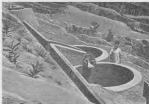
Водоприемный лоток и мерные баки стоковой площадки, на которой посажена акация. Научная противозерозионная станция в уезде Лишань провинции Шаньси.
