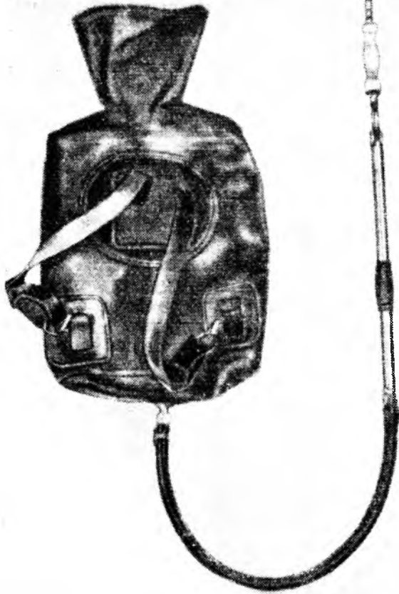
Ранцевый опрыскиватель конструкции ЛенНИИЛХ.
