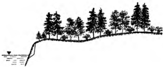
Рис. 4. Схема размещения защитных лесонасаждений на крутых и обрывистых берегах.
