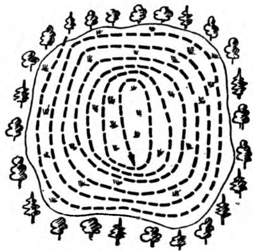
Рис. 2. Схема движения якорного покровосдиравателя в процессе работы.
