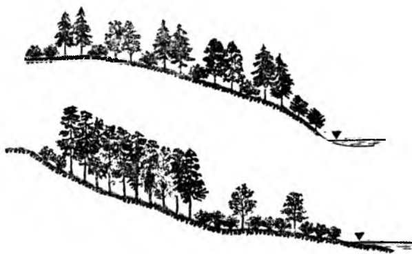
Рис. 2. Схема размещения защитных лесонасаждений на равнинных и пологих берегах, примыкающих к мелководьям.
