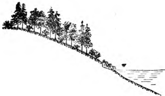
Рис. 3. Схема размещения защитных лесонасаждений на перерабатываемых берегах.
