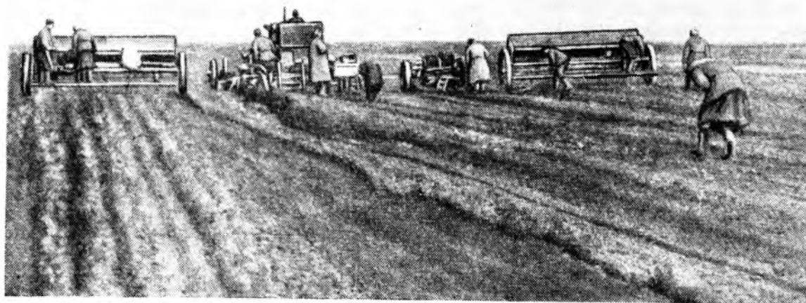
Рис. 3. Желудевая сеялка СЖ-2 в агрегате на тяге трактора С-80.
