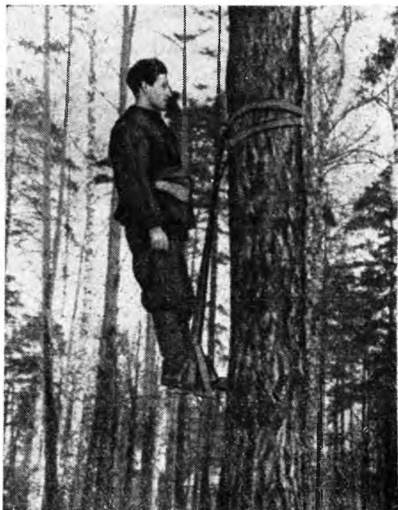
Рис. 5. Процесс подъема по стволу (крепежные ремни и рамка предохранительного пояса удерживают рабочего от падения назад).
