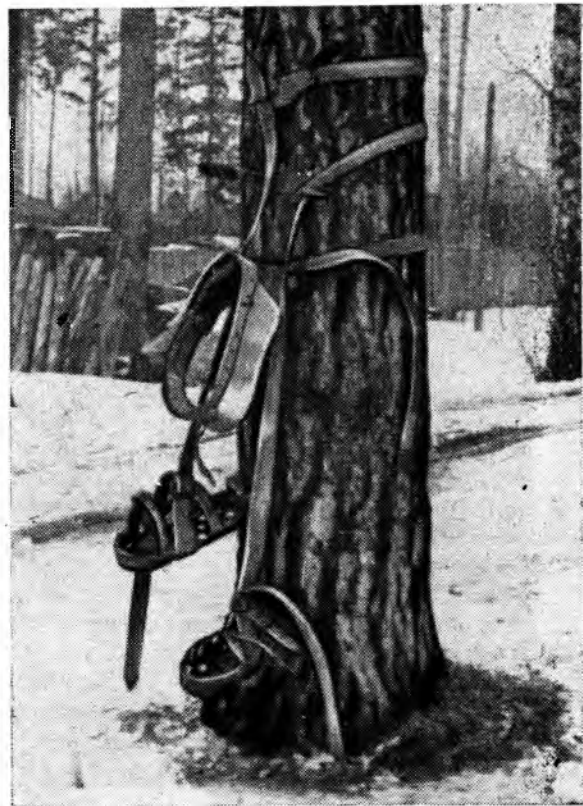
Рис. 2. Оснастка лазов на стволе дерева.
