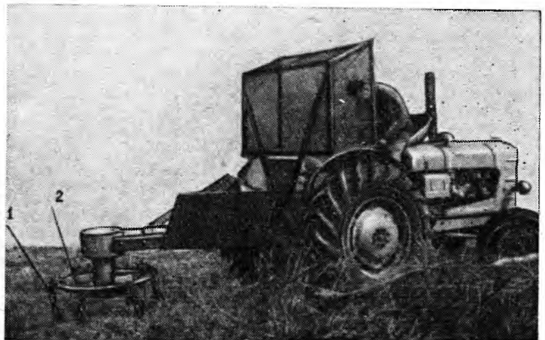
Рис. 3. Кусторез фирмы «Артур Ротари Слешер».
