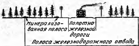
Рис. 2. Схема устройства минерализованных полос в полосе железнодорожного отвода.
